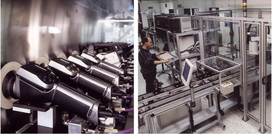
**Abbildung 17.5 LINKS:** Testen von Infrarotkameras in der Klimakammer; **RECHTS:** Roboter zum Testen und Kalibrieren von Kameras
