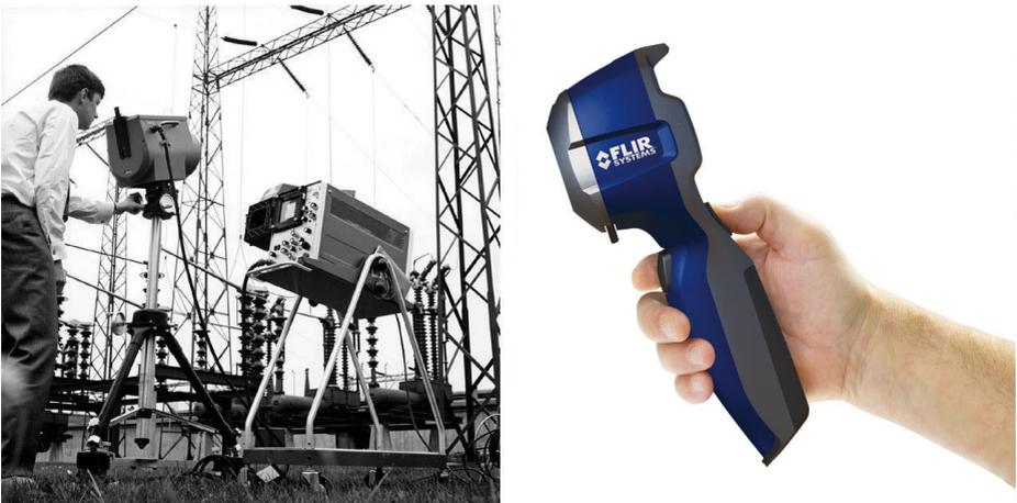
**Abbildung 17.2 LINKS:** Modell 661 der Thermovision® aus dem Jahr 1969. Die Kamera wog ca. 25 kg, das Oszilloskop 20 kg und das Stativ 15 kg. Für den Betrieb wurden darüber hinaus ein 220-Volt-Generator und ein 10-Liter-Gefäß mit flüssigem Stickstoff benötigt. Links neben dem Oszilloskop ist der Polaroid-Aufsatz (6 kg) zu erkennen. **RECHTS:** Die FLIR i7 aus dem Jahr 2009. Gewicht: 0,34 kg einschließlich Akku.
